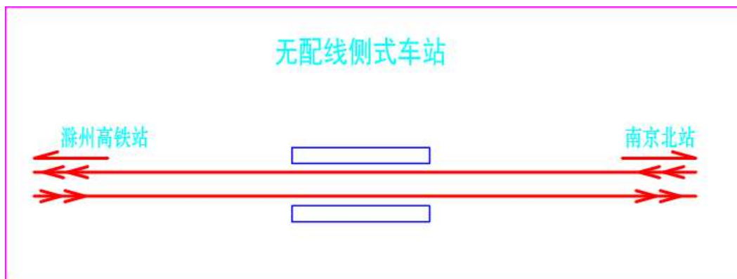
图 2.1-5 侧式站台布置型式
